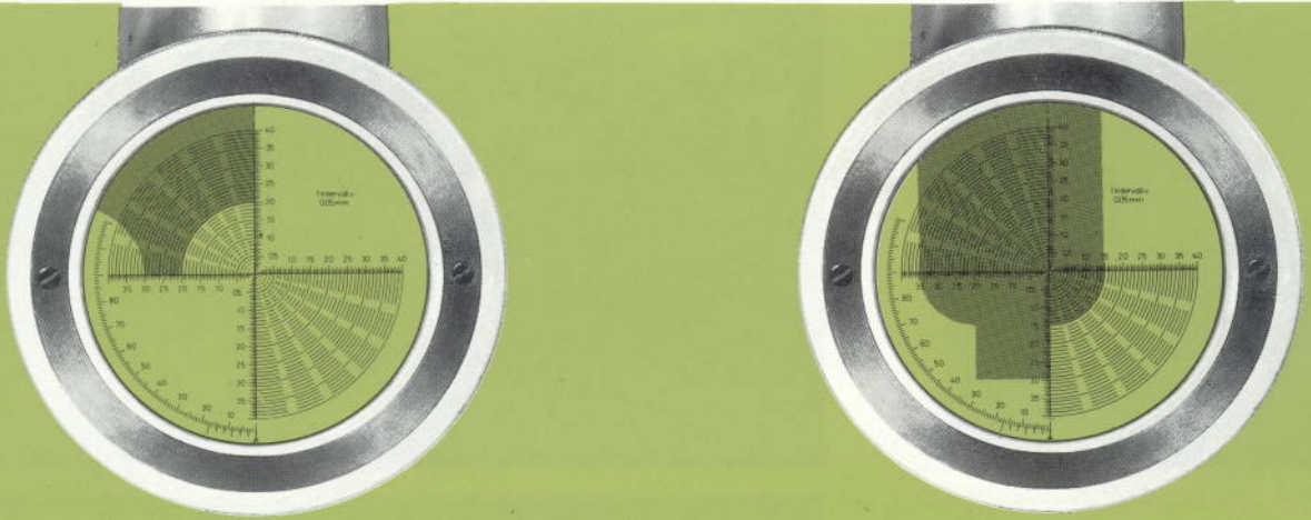
Abb. 7 Projektionsbeispiele von Profilformen an Einschnidefräsern
