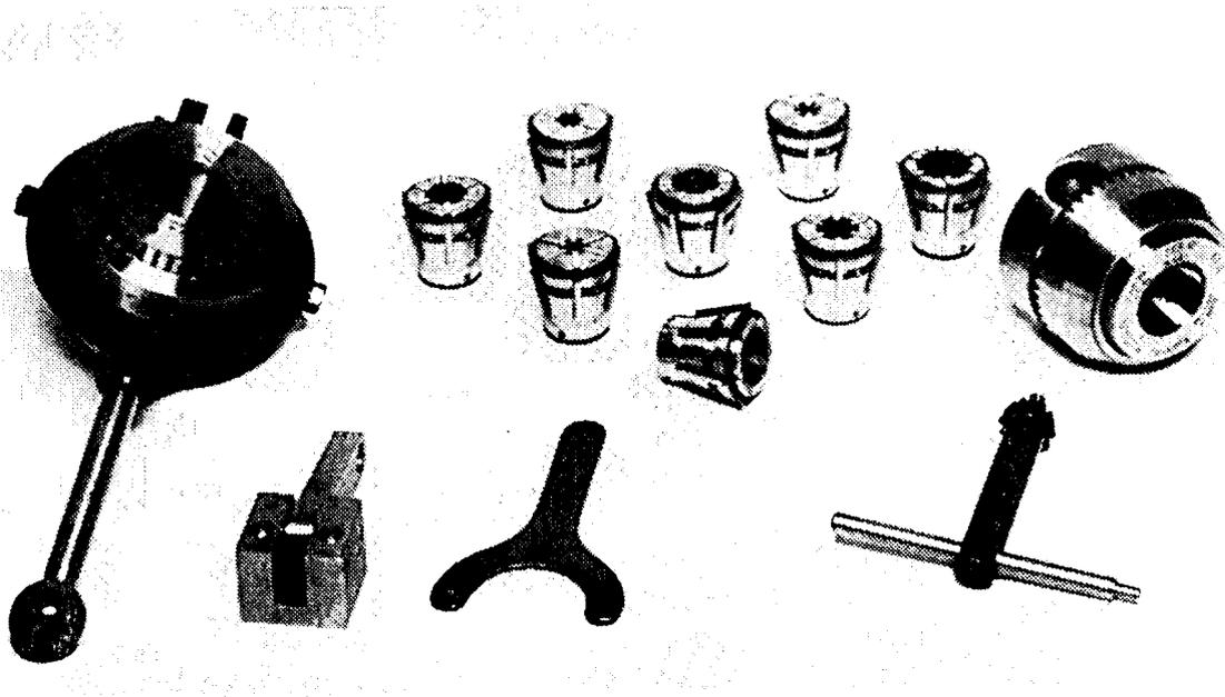
Fig. 129. Multisize Collet Chucks
