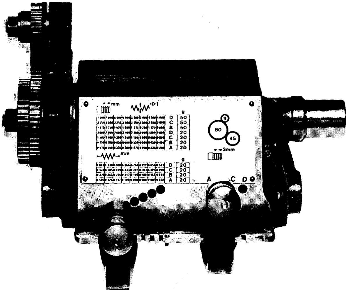
Fig. 17. Quick Change Gear Box
