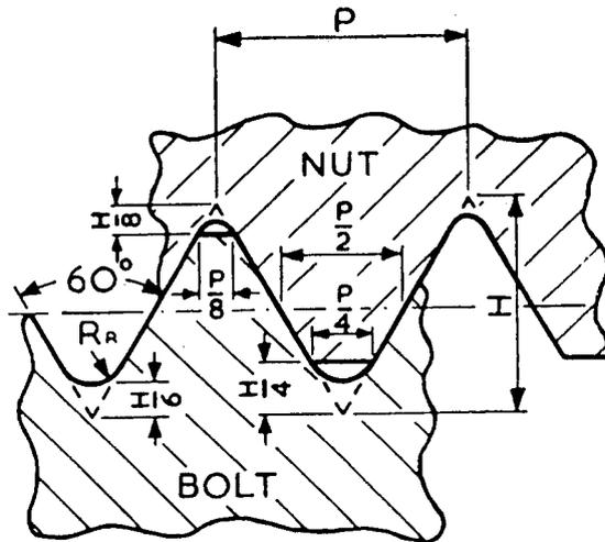
Fig. 146. ISO Metric Thread Form
